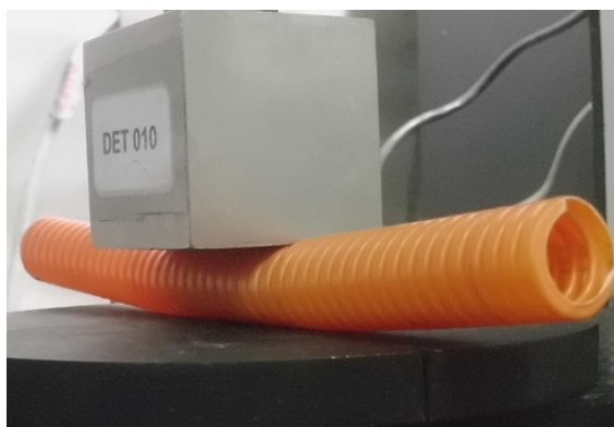
Detalhe: Corpo de prova durante ensaio de resistência à compressão
